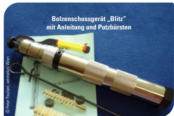
Abb. 6: Bolzenschussgerät Bauart „Blitz“ in ordentlichem Wartungszustand
