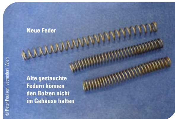
Abb. 8: Gestauchte Federn führen dazu, dass der Bolzen vor der Schussabgabe nicht im Gehäuse versenkt bleibt
