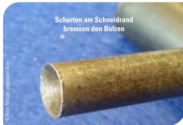
Abb. 9: Scharten am Schneidrand des Bolzens führen dazu, dass der Bolzen im Gehäuse reibt oder steckt
